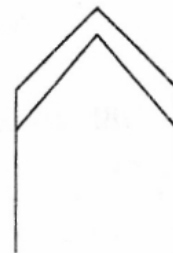
Angulo de reposo mayor que ángulo del techo
